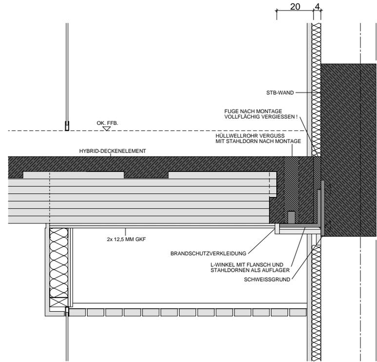
ANSCHLUSS KERN (SCHACHT) MIT DECKENKOFFER
