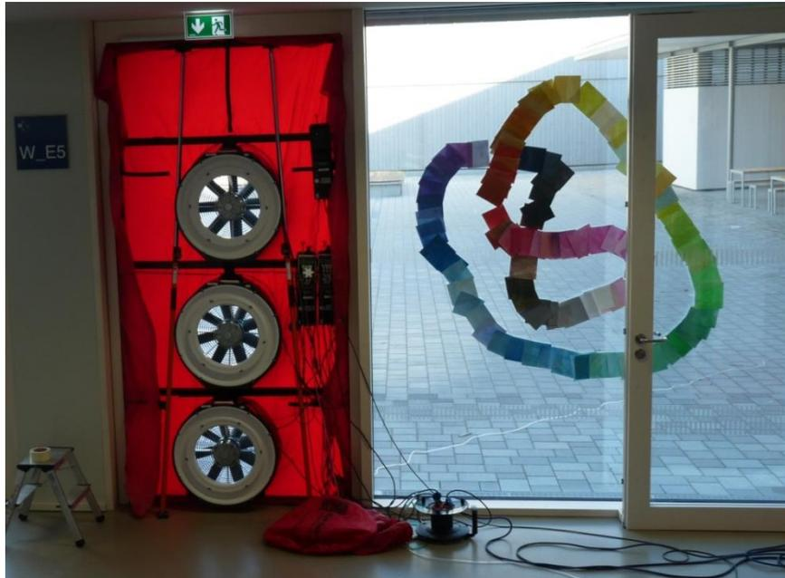
*Abbildung 2.3-37: Installation des Blower-Door-Messgerätes*
